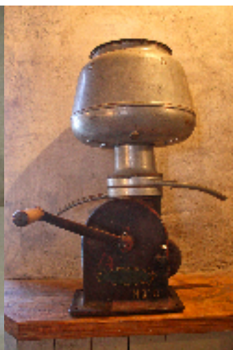
Gammaldags handvevad separator med kropp av gjutjärn. Foto: Petter Bergström.
