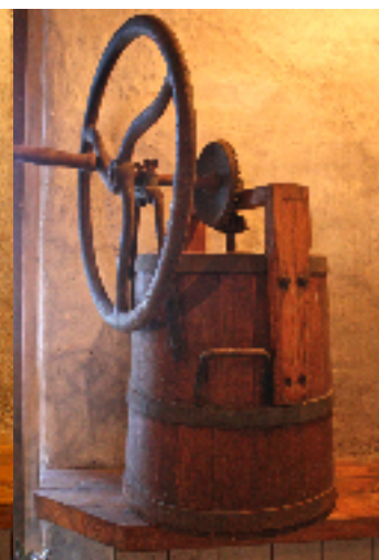
Gammaldags handvevad smörkärna med tunna i ek och hjul i gjutjärn. Stor modell, ca 12 liter. Foto: Petter Bergström.
