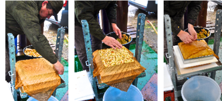
OVAN: Ovanpå en ram i rostfritt läggs pressduken. Fruktmassan packas jämt i duken som sedan vikas över fruktmassan så att fruktmassan blir helt innesluten. Därefter tas ramen bort och ett nytt mellanlägg läggs på.
